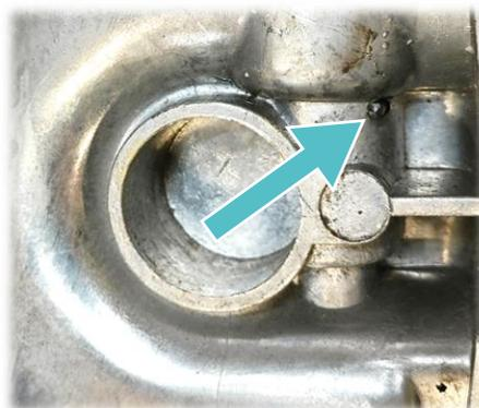
Nun wird der Adapter für den KOSO-Geschwindigkeitssensor bis zum Anschlag eingesetzt (Gewinde muss in Richtung Hinterrad zeigen) und muss mit dem Passkerbstift gesichert werden. Diesen dazu von der Außenseite des Limadeckel aus bis zur Bündigkeit eintreiben.
