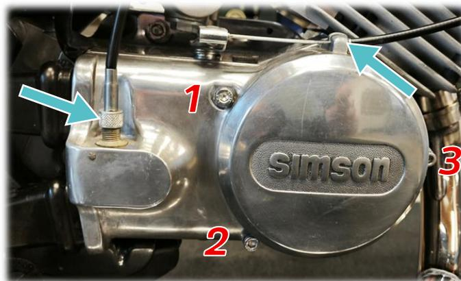
Der Passkerbstift (siehe Pfeil), der das Lagerstück im Lima-Deckel hält, muss von innen heraus mit einem geeigneten Werkzeug (Splinttreiber o. Schlagdorn) ausgetrieben werden.
